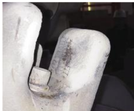
图3 烧蚀严重的静触头
